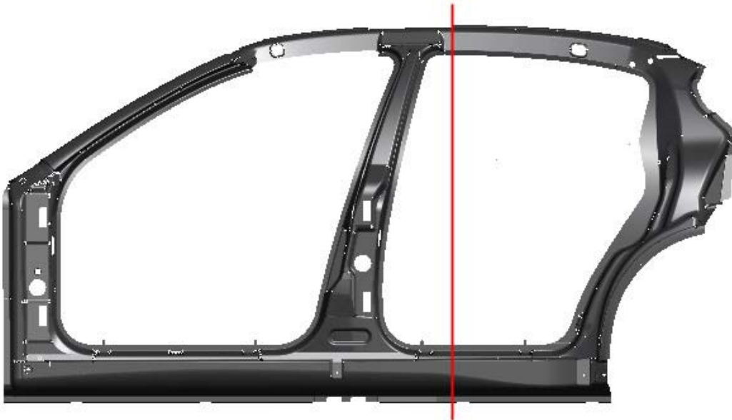
La linea rossa rappresenta la zona in cui è meglio tagliare il telaio
