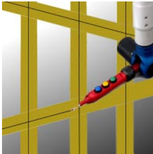
Particolare di una superficie preparata per scansione con braccetto
